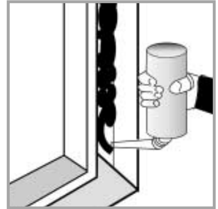
6 Tiivistä karmin ja elementin välit vaahdolla.
