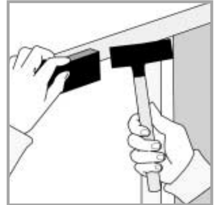
6 Naputtele sisäpuolen laipat paikoilleen. Huom. Käytä aina iskua vaimentavaa alustaa, esim. puun palasta.
