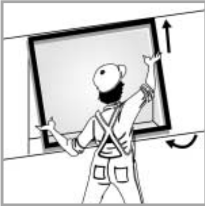
4 Nosta ikkuna paikoilleen.
