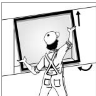
4 Lyft fönstret på plats.
