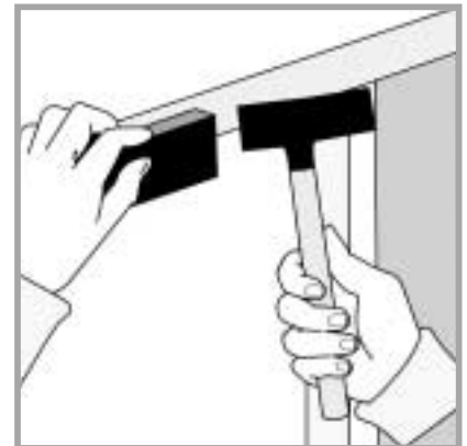
6 Slå inre sidans flansar på plats. Obs. Använd alltid ett tryckutjämnande underlag, t.ex. en träbit.
