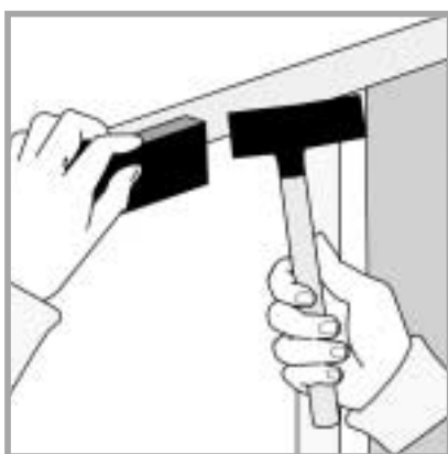
7 Slå inre sidans flansar på plats. Obs. Använd alltid ett tryckutjämnande underlag, t.ex. en träbit..
